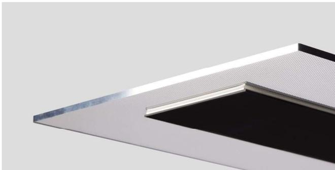
Das LGP koppelt seitlich eingebrachtes Licht durch integrierte Prismenstrukturen gleichmäßig über die Plattenfläche wieder aus. Die optisch wirksamen Strukturen stellen keine diffus streuenden Elemente dar, sondern nutzen Reflexion und Refraktion als grundlegende Prinzipien. Der direkte Lichtanteil ist im Allgemeinen entblendet und bietet höchsten visuellen Komfort.
